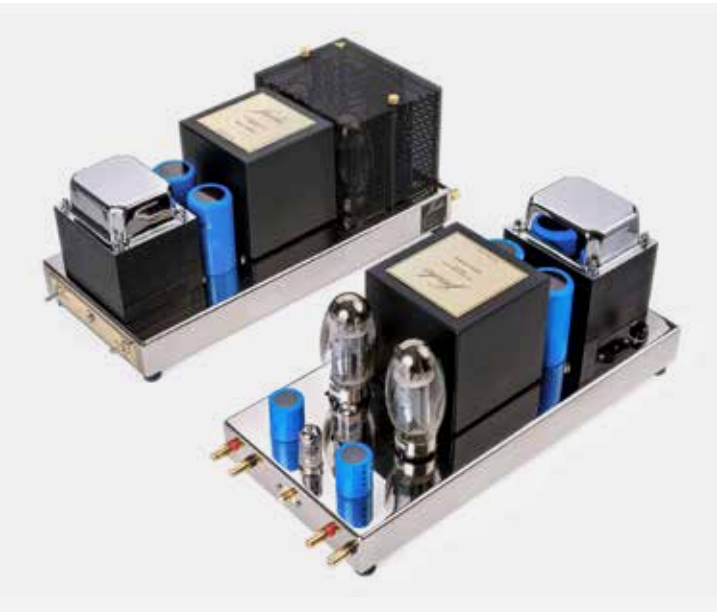
V domácích podmínkách se spíše než explozivní hlasitost cení autentická a emotivní reprodukce. S adekvátně citlivými reprosoustavami patří triodové zesilovače o výkonu pár wattů téměř ke svatému grálu (například Jadis SE300B).
